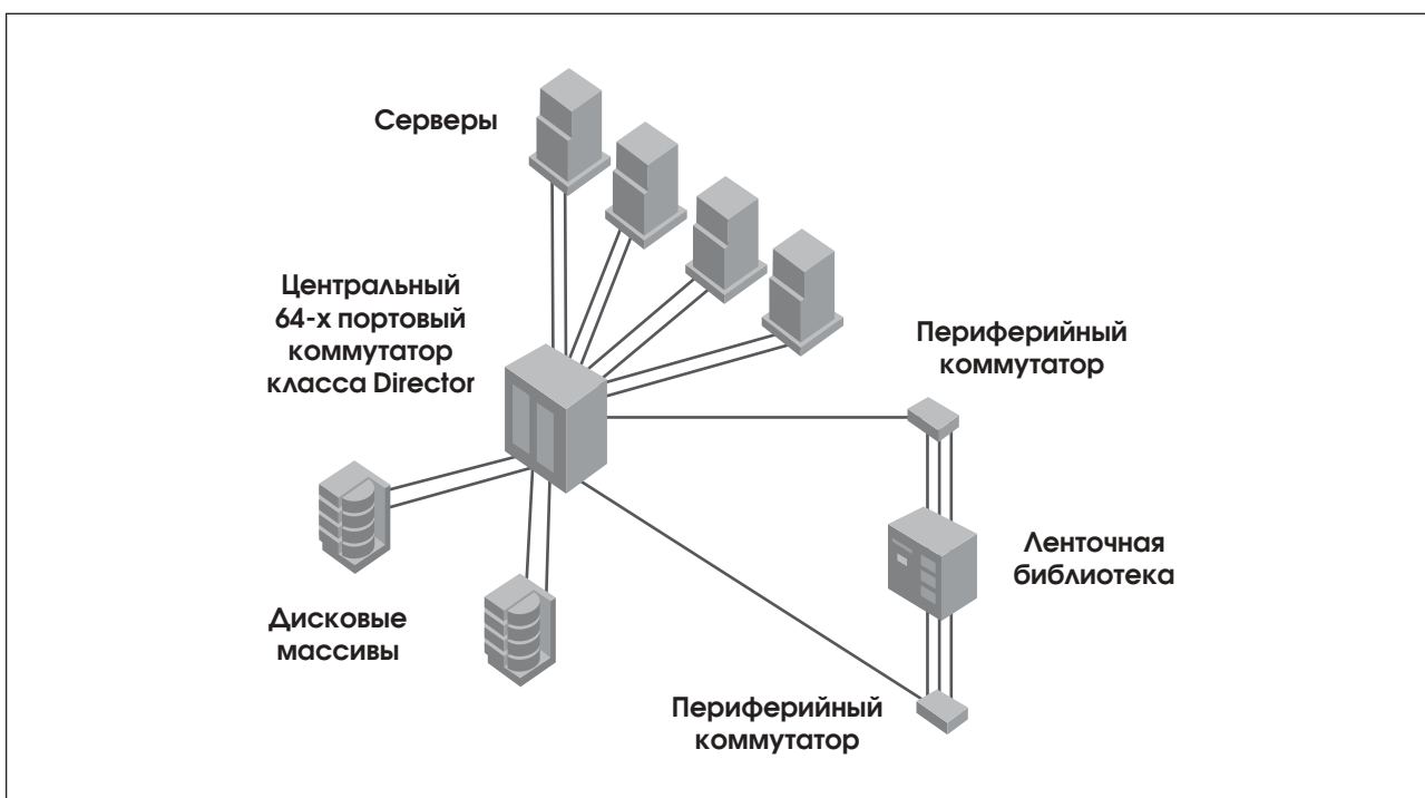
Рис. 11. Иллюстрация реализации SAN на основе коммутатора класса Director
