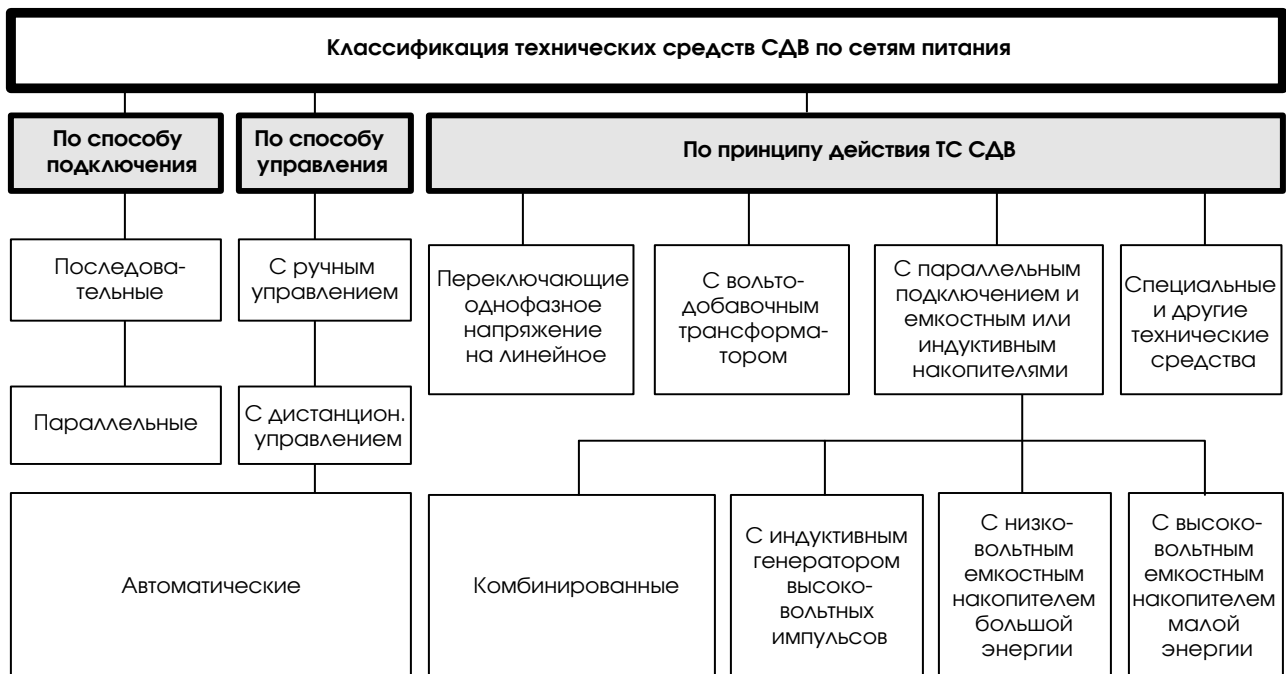
Рис. 4. Классификация технических средств СДВ по сетям питания.
