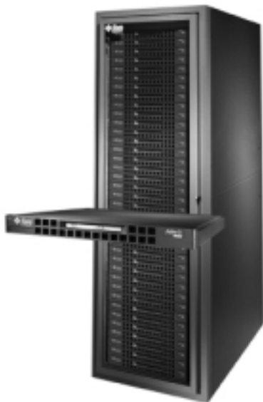
Рис. 7. В стойку можно установить 40 серверов Netra t1.
