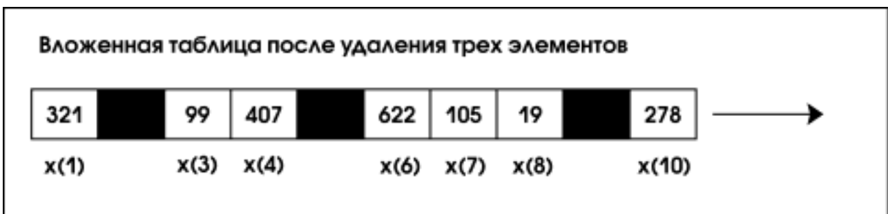
Рис. 3. Вложенная таблица как одномерный массив.
