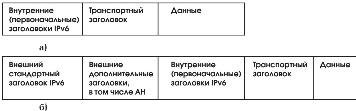
Рис. 29. Пакет IPv6 до (а) и после (б) применения протокола АН в туннельном режиме.
