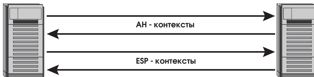
Рис. 24. Протокольные контексты безопасности, необходимые для двустороннего обмена данными с применением протоколов AH и ESP.
