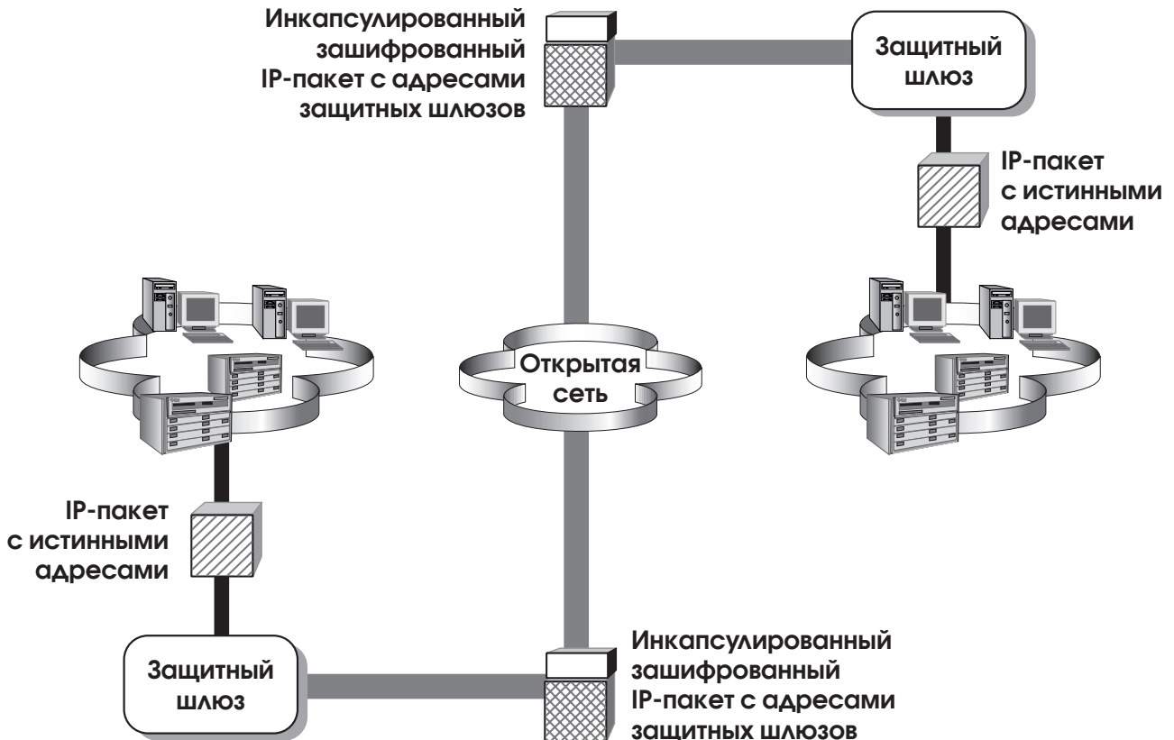
Рис. 21. Функционирование средств IP-безопасности в туннельном режиме.
