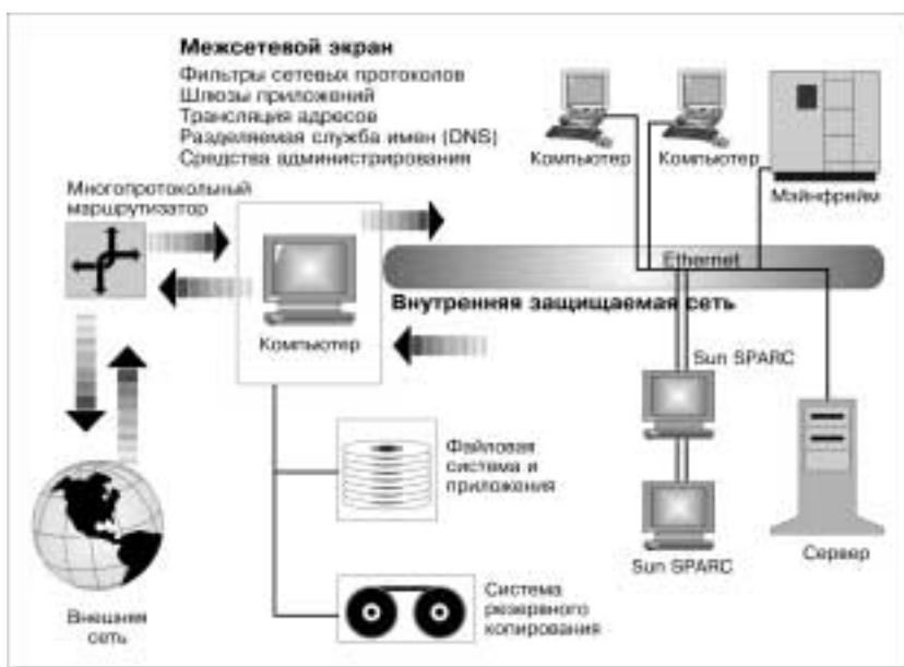
Рис. 1. Общая схема подключения межсетевого экрана “Застава-Джет”.
