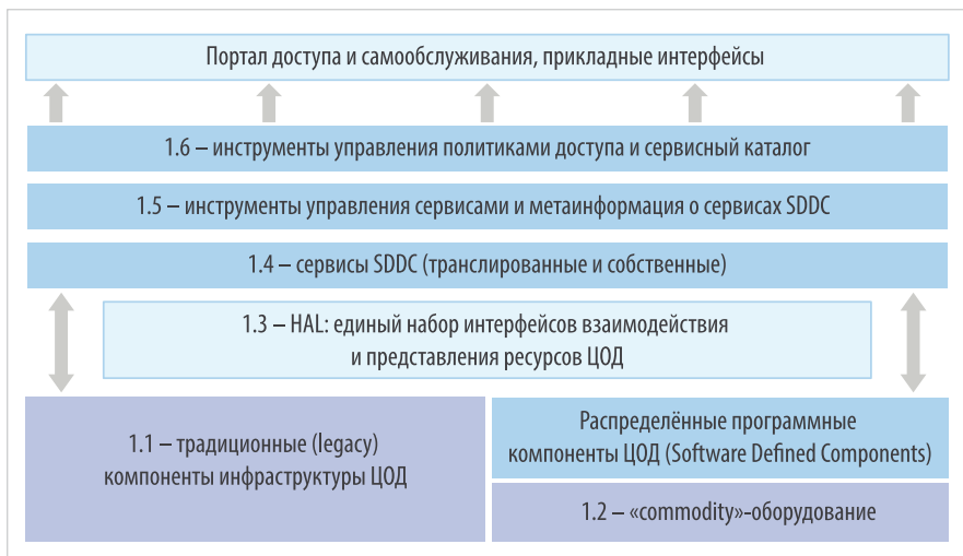
Рис. 1. Структура программно-определяемого ЦОД
