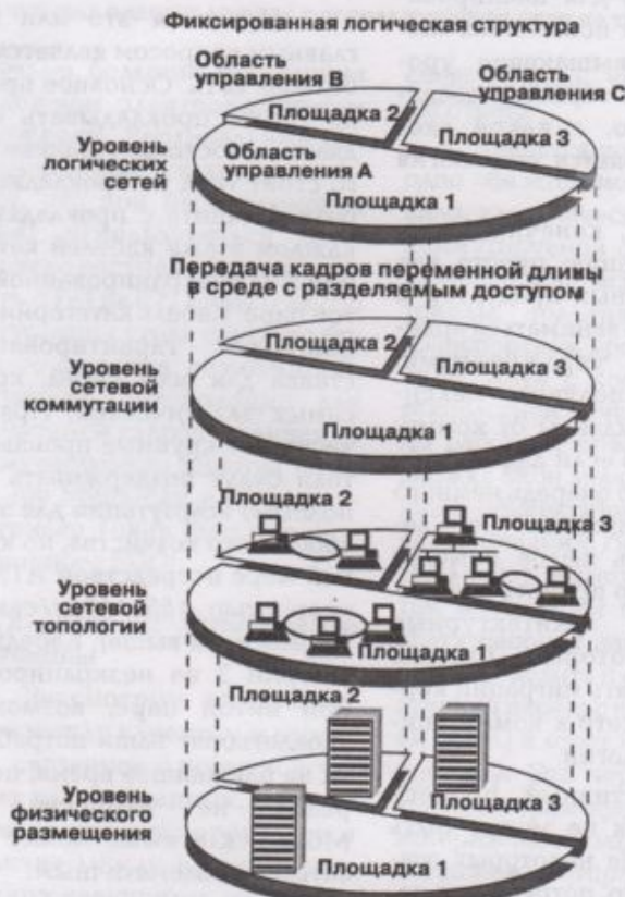
Рис. 2. Привычная широко- вещательная корпоративная сеть с разделяемым доступом. Традиционные мосты и маршрутизаторы перемещают по сети кадры переменной длины. Пропускная способность одних устройств больше, чем у других, но каждое из них в принципе не может одновременно поддерживать несколько потоков данных. Группы пользователей и ресурсов определяются жесткими рамками, заданными расположением сетевых устройств.
