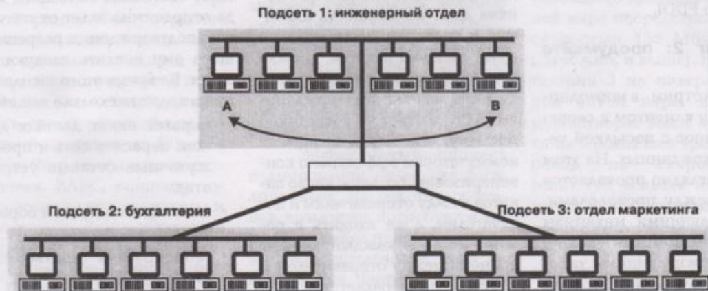
Рис. 4. Сегментация с помощью маршрутизатора. Маршрутизатор использован для проведения политических границ между подразделениями в большой корпоративной сети.
